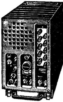
**Fig. 4** Per la ricezione, sono adattissimi i ricevitori surplus BC603 o BC683; il loro aspetto esteriore è quello visibile in figura.
