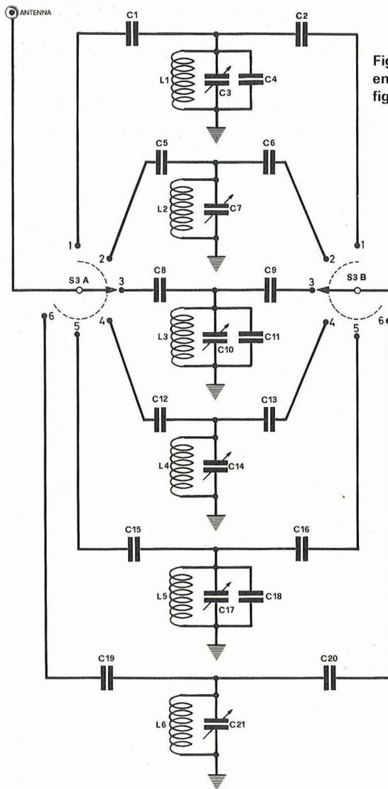
Fig. 3 Utilizzando un variabile a 6 sezioni lo stadio di entrata va modificato come indicato nello schema di figura.
