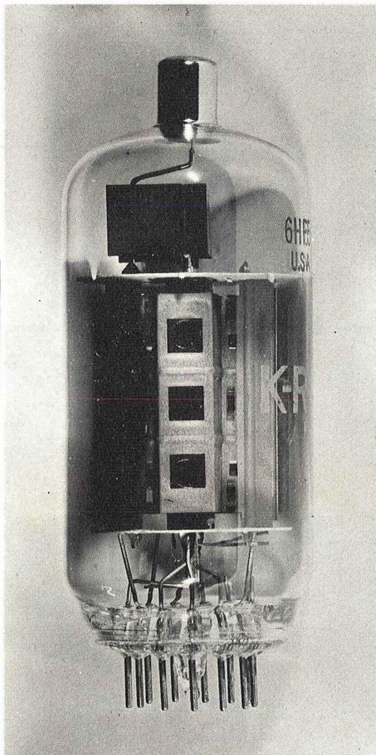
Di lato è visibile la valvola 6HF5, che noi abbiamo impiegato in questo amplificatore lineare. Come spiegato nell'articolo è possibile usufruire, per tale realizzazione, anche di altri tipi di valvole.
