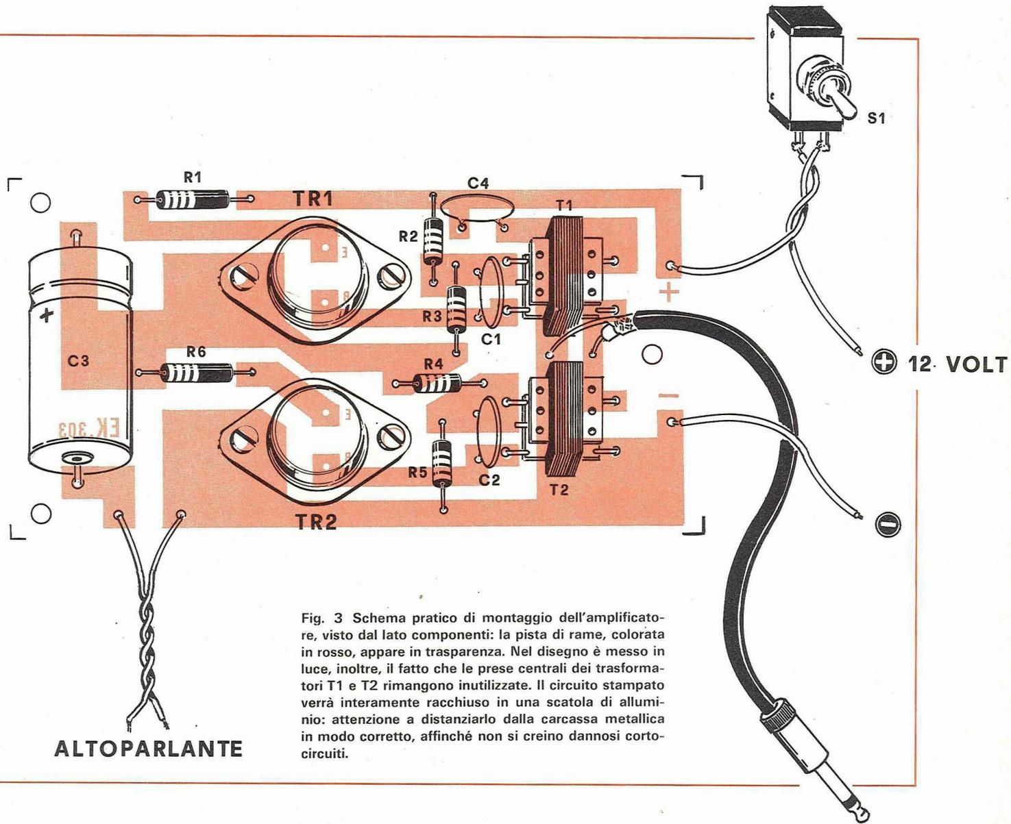
Fig. 3 Schema pratico di montaggio dell'amplificatore, visto dal lato componenti: la pista di rame, colorata in rosso, appare in trasparenza. Nel disegno è messo in luce, inoltre, il fatto che le prese centrali dei trasformatori T1 e T2 rimangono inutilizzate. Il circuito stampato verrà interamente racchiuso in una scatola di alluminio: attenzione a distanziarlo dalla carcassa metallica in modo corretto, affinché non si creino dannosi cortocircuiti.
