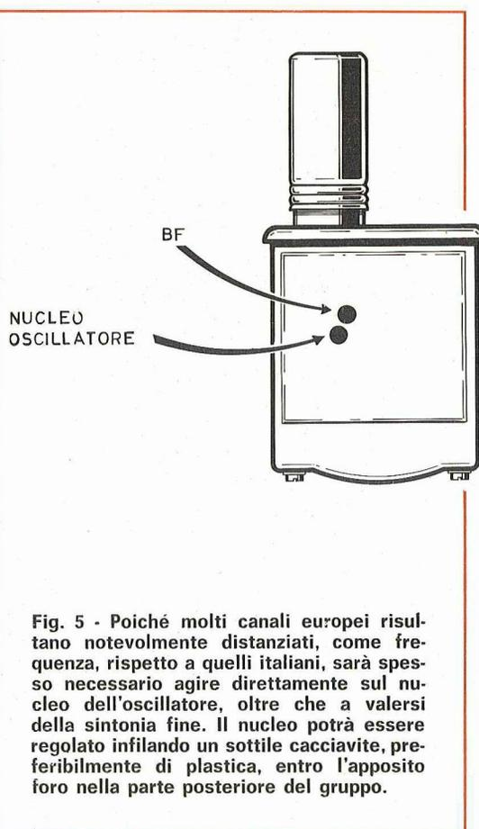
**Fig. 5 - Poiché molti canali europei risultano notevolmente distanziati, come frequenza, rispetto a quelli italiani, sarà spesso necessario agire direttamente sul nucleo dell'oscillatore, oltre che a valersi della sintonia fine. Il nucleo potrà essere regolato infilando un sottile cacciavite, preferibilmente di plastica, entro l'apposito foro nella parte posteriore del gruppo.**
