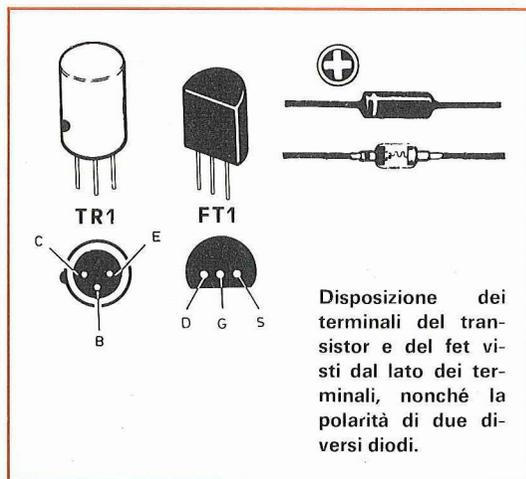
Disposizione dei terminali del transistor e del fet visti dal lato dei terminali, nonché la polarità di due diversi diodi.
