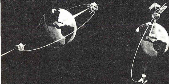
Fig. 3 Questo disegno, gentilmente inviatoci dalla NASA, mostra come sono inclinati rispetto all'equatore due diversi tipi di satelliti meteorologici. Come si nota, i satelliti della serie TIROS seguono un'orbita con una inclinazione variabile dai 48° ai 58°, mentre quelli della serie NIMBUS hanno un'orbita che forma col l'equatore un angolo variante dai 100° ai 102°. I gradi di inclinazione vanno contati partendo da destra verso sinistra.
