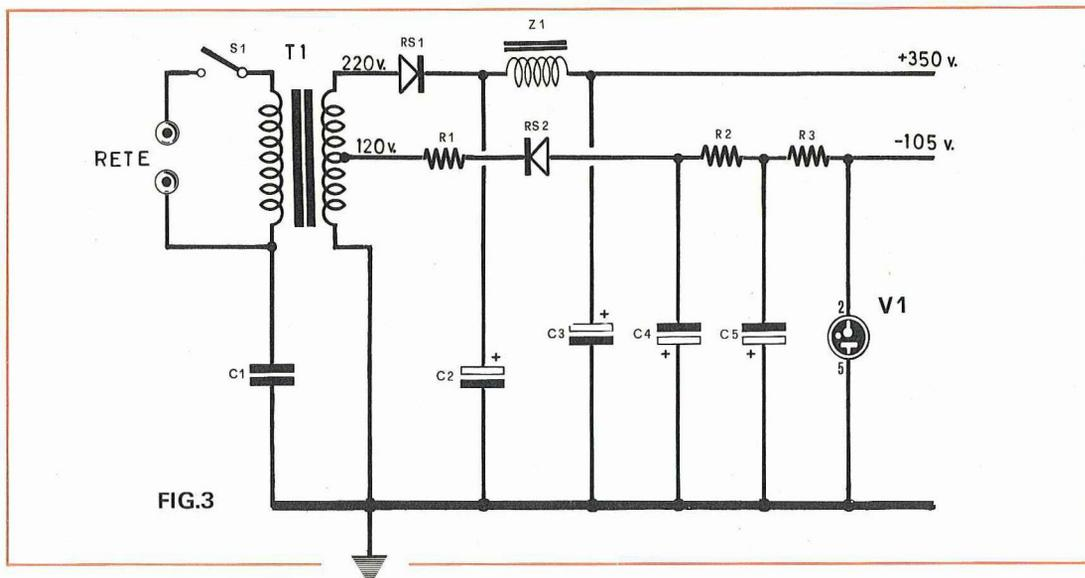
T1 = trasformatore 40/50 watt con secondario
