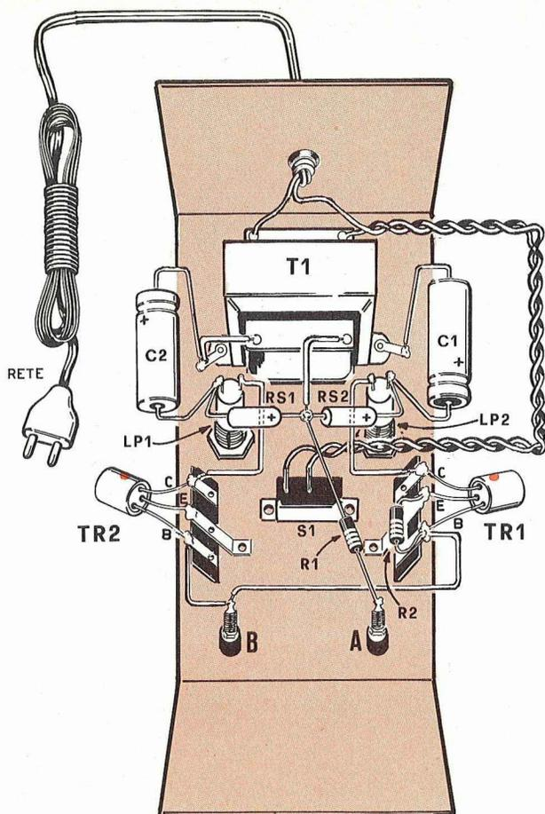
**Schema pratico di montaggio del provadiodi descritto nell'articolo. Nella realizzazione occorrerà fare attenzione alla connessione dei terminali dei transistor; come si nota dal disegno, l'emettitore va stagnato al terminale dell'ancoraggio collegato a massa.**
